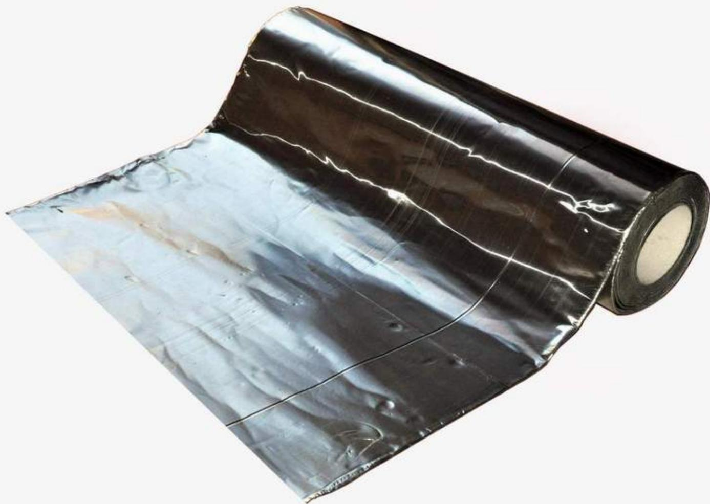
Materiale antivibrante adesivo a base BUTILICA con strato superficiale in ALLUMINIO, peso 3,00 Kg al mq. In grado di abbassare la frequenza di risonanza della parte a cui viene applicato e di ridurre/eliminare vibrazioni primarie e spurie dissipando tali vibrazioni in calore, fortemente modellabile e facilmente tagliabile.
